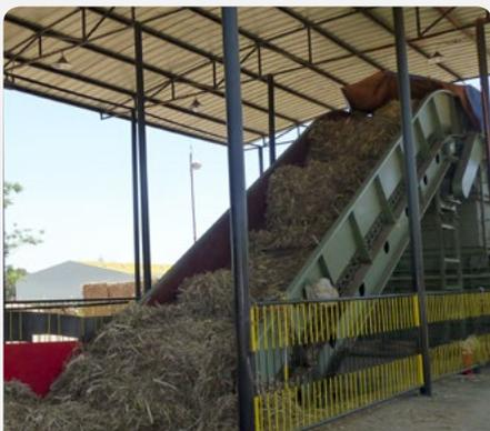
Bagasse wird auf einem Förderband zur Ballenpresse transportiert.
